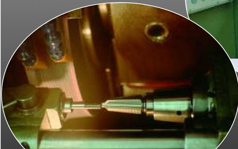
Hinterschleifen von Stufenbohrern
